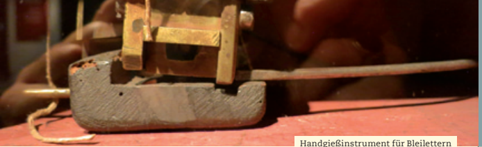
Handgießinstrument für Bleiletern
