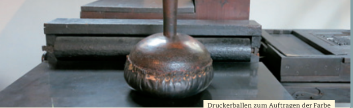
Druckerballen zum Auftragen der Farbe
